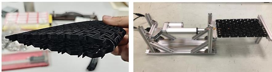
设计了一种由反手性四韧带单元与内凹单元混合形成的蜂窝结构，将其作为机翼的骨架或蒙皮的芯材，利用这种力学超材料的负泊松比效应，实现变体机翼大变形目的，并能有效降低机翼重量。
