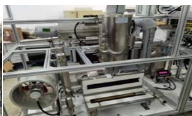
发动机燃料重整试验台
